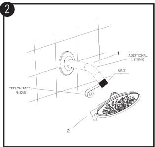
按照上图安装花洒头, 花洒弯管连接处要缠上生胶带。将花洒头(2) 拧在花洒弯管(1)上,并用扳手拧紧。拧紧的时候,要用一只手
