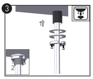
安装垫片及螺母,确保安装螺母距离底面小于12毫米。
