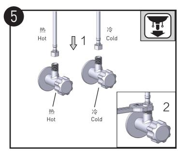
将龙头冷热水管分别连接到冷热进水口。
