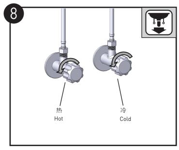
打开冷热角阀,检查是否漏水。
